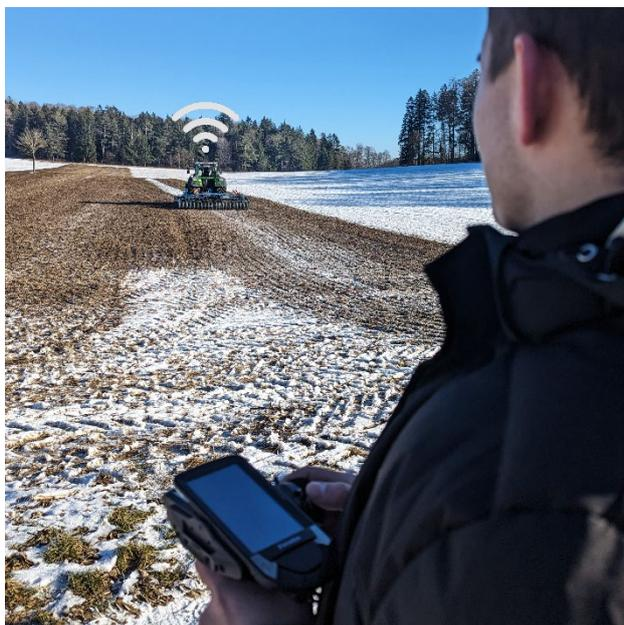
*Durch die Digitalisierung bislang manueller oder hydraulischer Fahrzeugfunktionen ist möglich, den Fendt 942 Vario auch per Fernsteuerung zu bedienen – ohne menschlichen Fahrer in der Fahrerkabine.*
