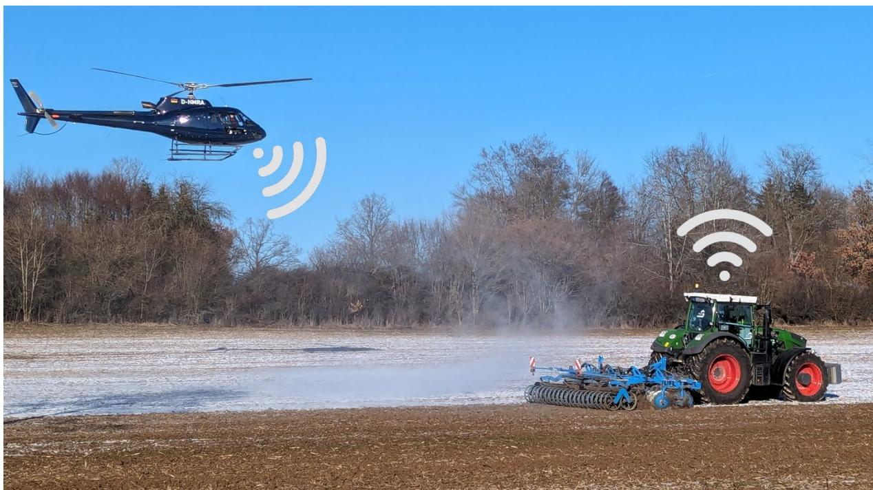
*Dieser Fendt 942 Vario wurde mit einem redundanten elektronischen Lenk- und Fahrsystem von Arnold NextG ausgerüstet und kann damit teleoperiert oder ferngesteuert gefahren werden – sogar vom Hubschrauber aus.*
