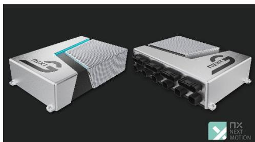
Das Zentralsteuergerät von Arnold NextG bietet eine fahrzeugunabhängige Systemlösung zur aus-fallsicheren Ansteuerung aller Primär- und Sekundärfunktionen sowie abgesicherte Schnittstellen für sämtliche AD-Systeme.
