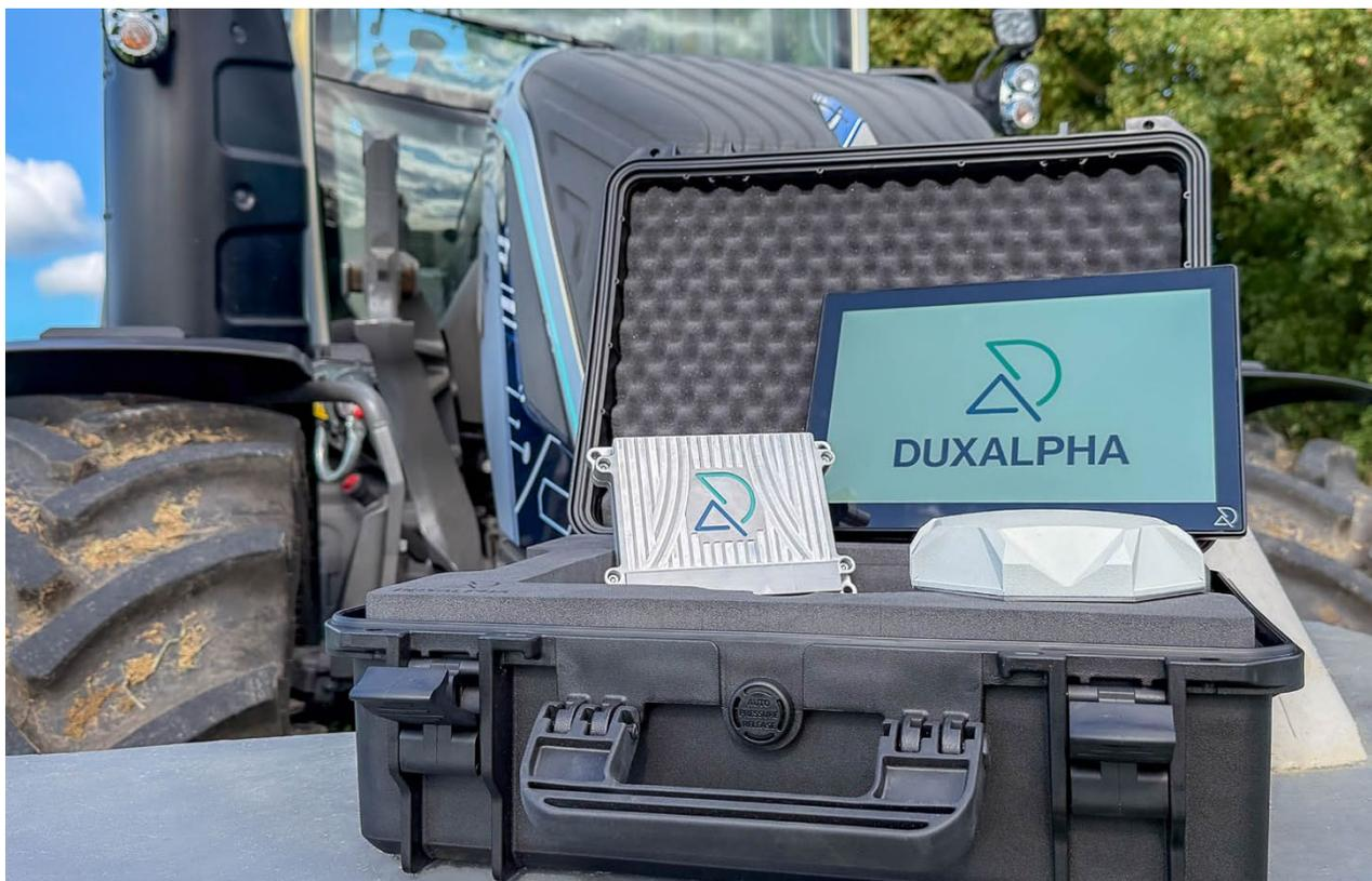
*Ausgezeichnete Technologie für den Acker der Zukunft: Das modulare DuxAlpha-System – bestehend aus Display, Recheneinheit und GNSS-Empfänger – ermöglicht 3D-genaue Spurplanung, Echtzeitvernetzung und automatisierte Dokumentation in einem nachrüstbaren Komplettpaket. Foto: Arnold NextG*
