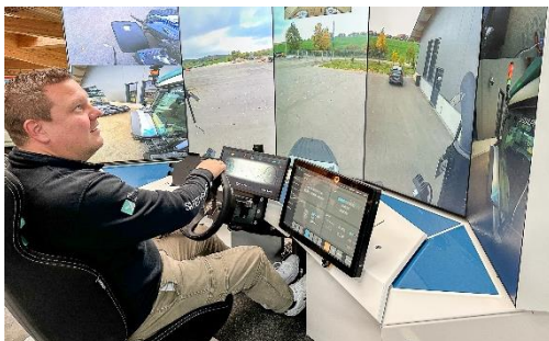
Blick in die Leitstelle: Der Teleoperator steuert den Traktor aus der Ferne – über Multiscreen-Visualisierung, Sensorfeedback und digitales Cockpit. Foto: Arnold NextG
