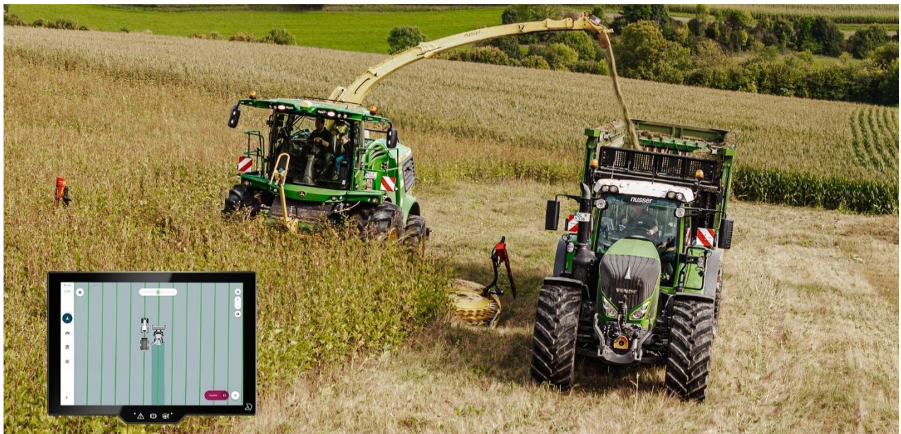
Autonom im Einsatz: NX NextMotion übernimmt die digitale Steuerung des Traktors, während DuxAlpha die 3D-Spurführung und Koordination der Maschinenflotte übernimmt – für präzise Arbeitsabläufe selbst im Hanggelände. Foto: Arnold NextG
