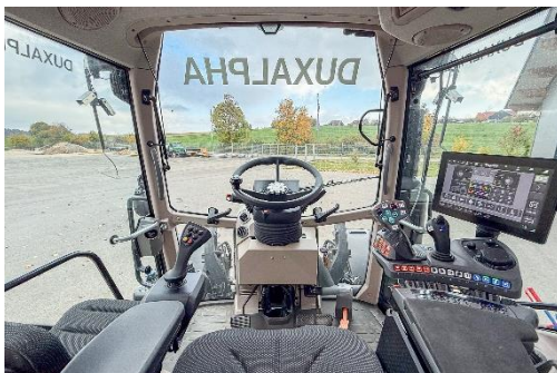
Im Einsatz: Der Traktor wird teleoperiert gefahren – das Kamerabild ersetzt die Sicht aus der Kabine, Steuerung und Systemüberwachung erfolgen vollständig aus der Leitstelle. Foto: Arnold NextG
