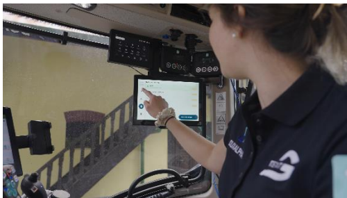
Zentrale Steuerungseinheit: Das DuxAlpha-Terminal im Traktor ermöglicht die Verwaltung von Aufgaben, Echtzeitdaten und Maschinenparametern direkt aus der Kabine – intuitiv, vernetzt und automatisiert. Foto: DuxAlpha
